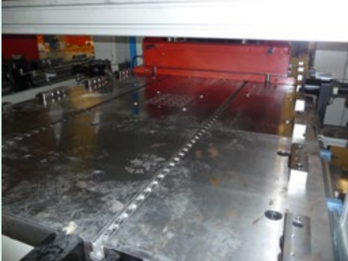
Système de bridage magnétique en combinaison avec règles à rouleaux pneumatiques et guidages latéraux.
