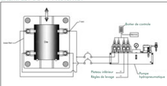
Vérins basculant simple effet ERC, vérins creux ECA ou MHC ou MTC avec séparation des circuits pour le coulisseau et la table machine et un circuit pour les règles à billes..
