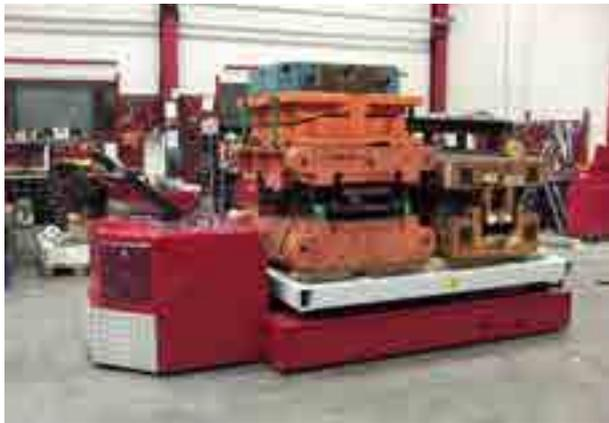
Ein Wechselwagen mit zwei Plätzen kann einen Formenwechsel in weniger als 15 Minuten durchführen, wenn die Presse zusätzlich mit einem Rollen- und Spannsystem ausgerüstet ist.
