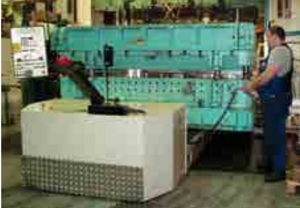
Falls die Form für den manuellen Transport zu schwer ist, kann ein batteriebetriebener von Hand gesteuerter Wechselwagen eine Lösung sein. Dieser kann mit höhenverstellbarer Rollbahn ausgestattet werden, um an unterschiedlichen Übergabehöhen an den Pressen und Lagerplätzen angepasst zu werden.
