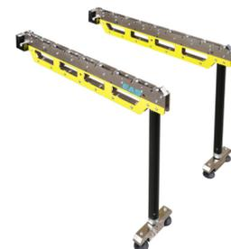
Les consoles d'EAS prolonge l'ouverture latérale des machines pour permettre un transfert manuel horizontal de matrice et de moule plus rapide et plus sécuritaire. Toujours monté par set, les consoles de EAS sont équipés de roulements à aiguilles avec des surfaces en acier trempé pour offrir une capacité de charge élevée. La matrice ou le moule est chargé sur les consoles à l'aide d'un chariot élévateur ou d'un pont roulant.
