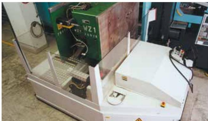
*1 x 20 t avec l'association d'un dispositif électrique et d'un système de suspension sur coussin d'air pour un positionnement exact en face de la machine, du stockage et de l'unité d'inspection.*
