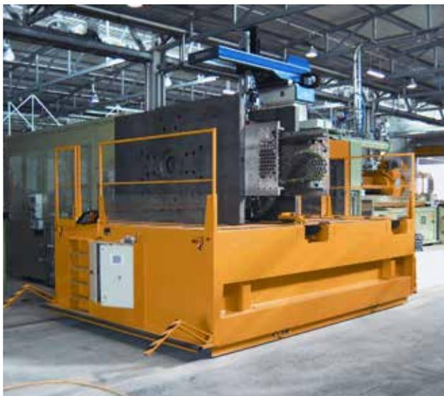
**Un pas supplémentaire vers l'automatisation est l'installation d'un système guidé par rail pouvant être utilisé pour une ou plusieurs machines ou même pour un rang complet de machines de moulage par injection.**
