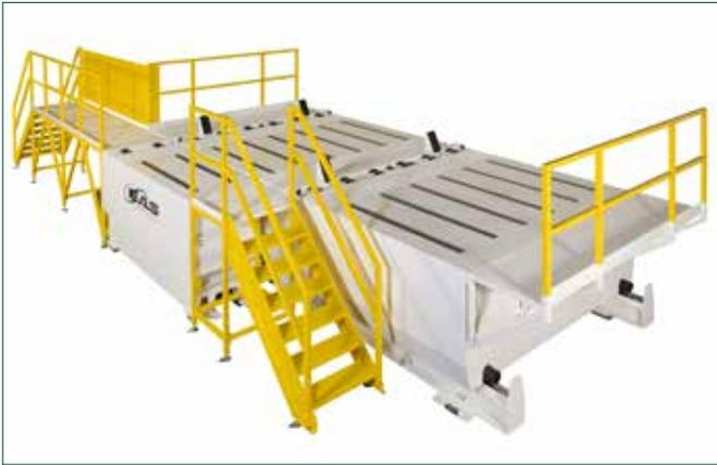
Table de changement pour deux moules de max 2 x 60 t. Cette table dispose d'une station de pré-chauffage avec coupleurs automatiques multi-connexions.
