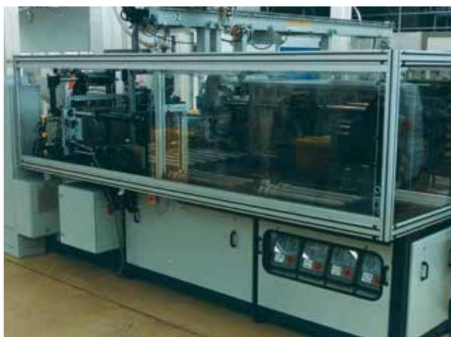
*Une cellule de production comprenant une machine 150 t avec une table de changement de moule 3 directions et 2 positions, équipée de système de préchauffage, de système multi-coupleurs, de bridage hydraulique avec centrale séparée et de système pour l'accouplement de l'éjection. L'équipement de préchauffage est aisément accessible sous la table.*
