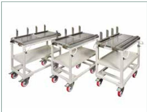
Chariots de changement de moules avec règles à rouleaux pilotées par air pour salles propres
