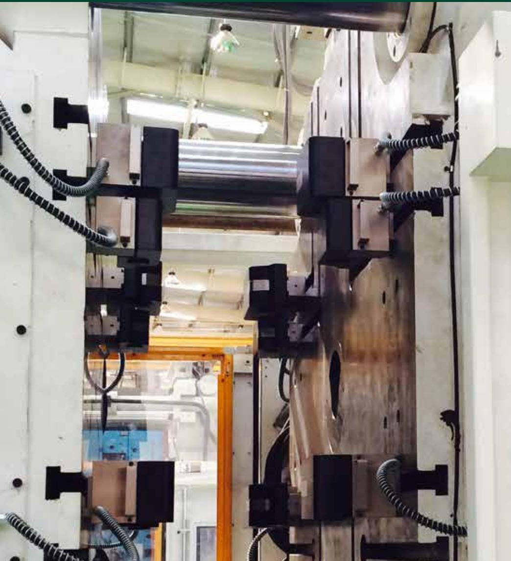
*Les vérins simple effet ERC peuvent-etre alimentés par une pompe hydraulique EAS avec 2 circuits par plateau pour raisons de sécurité.*
