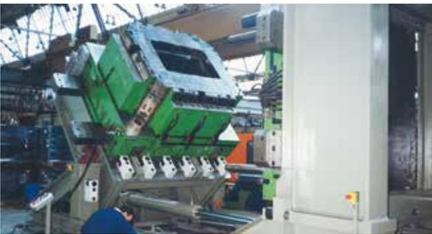
Pour ce reconnu fabricant allemand de poubelles plastiques, EAS a équipé plusieurs machines d'injection, jusqu'à 6000 t, d'un système de bridage hydraulique, a fourni un chariot de manutention de moules sur coussins d'air, et une unité d'inspection pour des moules pesant jusqu'à 100 t.
