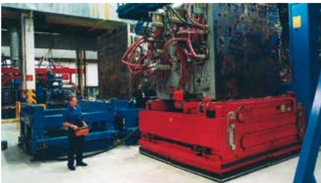
Pour des moules extrêmement lourds chez ce fabricant de conteneurs, EAS a installé ce dispositif avec suspension sur air, en association avec le système de stockage, des machines de moulage par injection de 3400 t et 6000 t, de même qu'une unité d'inspection EAS. Le chariot peut supporter un moule d'un poids maximum de 150 t et le changement est réalisé en moins de 30 minutes.
