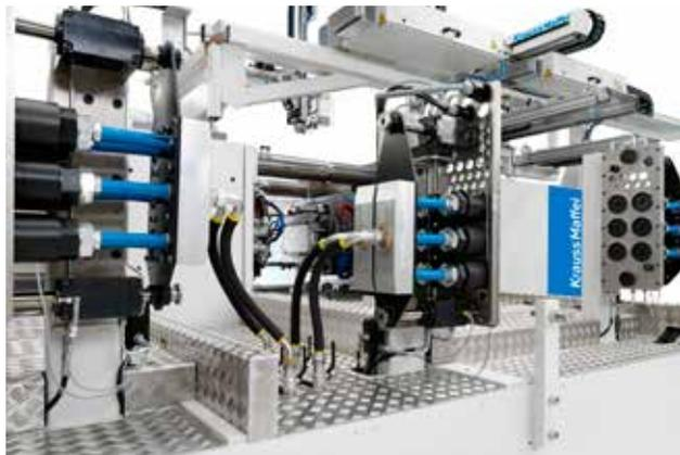
*Station de préchauffage intégrée sur une table de changement de moule avec des multi-coupleurs automatiques, coupleurs étanches pour les circuits d'huile chaude et coupleurs pour les connexions électriques.*
