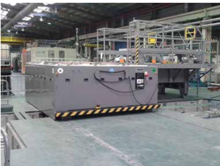
Les tables et les chariots EASchangesystems sont construits à partir d'une conception modulaire. Gamme de poids moules à partir de 5 t à 100 t. L'installation EAS chez le client.
