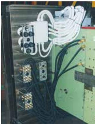
*Un multicoupleur manuel pour plusieurs jonctions électriques pour des signaux de chaleur et des capteurs, un multi-coupleur manuel avec 12 connexions hydrauliques standards, de taille 12 pour un flux de quantité d'eau suffisante pour les circuits de refroidissement. Des postes de stationnement pour ranger les multi-coupleurs manuels pendant un changement de moule. Ces solutions ont été réalisées sur cinq machines de 1300 t.*
