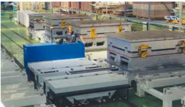
Ce chariot électrique, pour le chargement de moules sur presse verticale, permet de déplacer les moules vers l'aire de stockage. Les moules sont alors rangés de part et d'autre du chariot. L'opérateur dispose d'une caméra et d'un écran pour un positionnement très précis du chariot. Le chargement et le stockage des moules de 10 à 20 t deviennent des opérations sûres et rapides.
