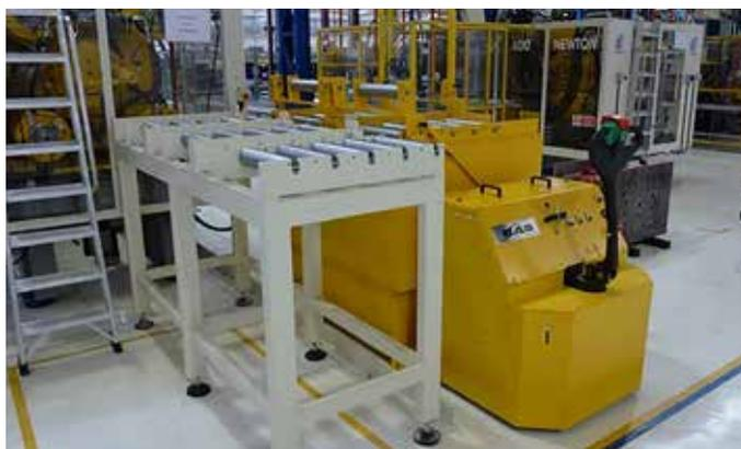
*1 x 7 t avec ajustement de la hauteur et transfert des moules par rouleaux motorisés.*
