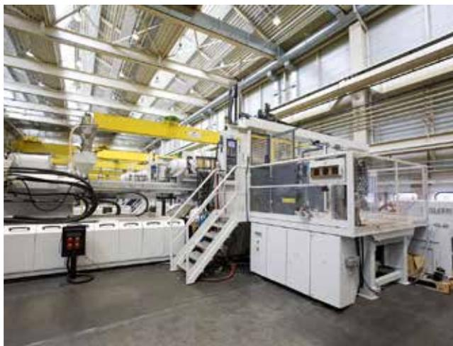
*Une table pour moules de 1 x 15t avec d'un côté les rouleaux avec guidage des moules, tandis que les autres rouleaux des moules de différentes dimensions peuvent être placés. Cette table a un panneau de commande fixe. Cette table comporte également deux guides pour permettre à l'opérateur du pont roulant de poser facilement le moule.*
