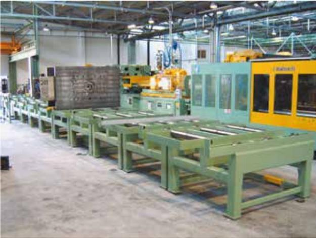
Racks de stockage de moule en combinaison avec un chariot de changement de moule sur rails. Un des racks de stockage est équipé de des multi coupleurs et sert de station de pré-chauffage.
