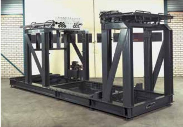
*Cette station distincte de préchauffage de moule est utilisée pour préchauffer des moules de 20 à 40 t à l'extérieur de la presse.*
