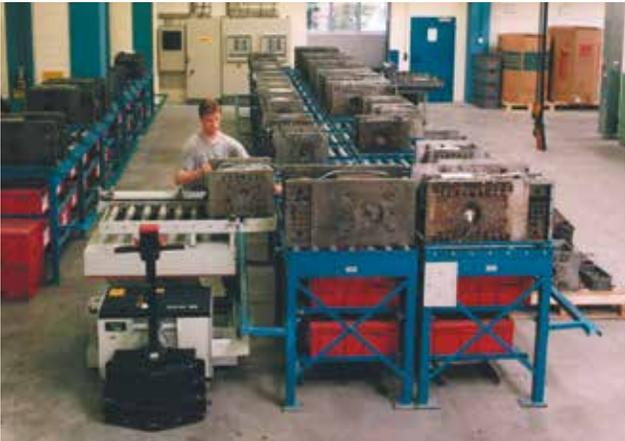
Les moules sont chargées et déchargées sur ces unités de stockage horizontal à l'aide d'un chariot à motorisation électrique, des espaces sont réservés sous les moules pour le rangement de pièces dédiés aux moules.
