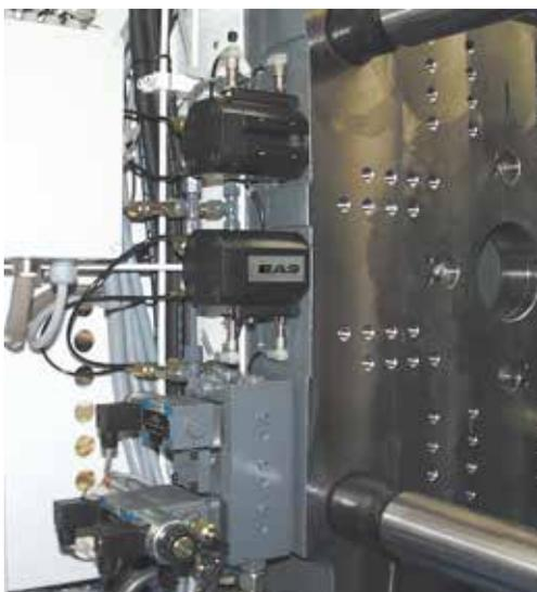
*Système hydraulique intégré avec contrôle des positions au moyen de deux détecteurs*
