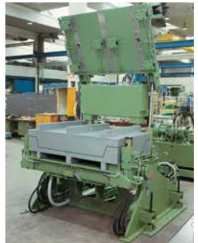
*Anneau spécial étudié avec un bridage intégré en "coin". Cet élément est utilisé sur une machine spéciale à fabriquer des jantes pour automobiles. L'auto blocage est la caractéristique de ce type de bridage. La pression hydraulique est suspendue après l'opération de bridage et pendant la rotation de l'anneau.*
