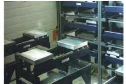
Les unités standards ont un longueur de 1200 mm, 580 mm de largeur et 275 mm de hauteur. Les deux plateformes tournantes sont de 350 x 350 mm. Optionnellement ces unités peuvent être sur une table de réhausse pour un meilleur accès. D'autres demandes sont réalisables comme des moyens de bridage. Contacter votre partenaire EASchangesystems pour en discuter.
