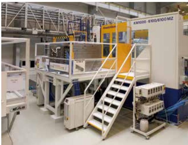
*Une machine d'injection de 1000 t équipée de bridage hydraulique pour chargement horizontal, un coupleur d'éjecteur, multi coupleurs automatiques, et d'une table de chargement pour un poids moule de maximum 15 t.*
