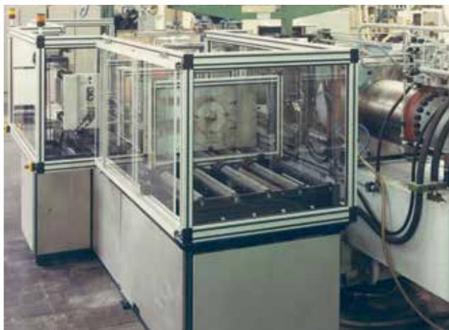
*Une cellule de production complètement automatique, avec un poste de préchauffage travaillant avec une machine de moulage par injection*
