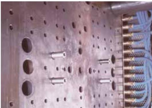
**Pour les machines avec les plateaux à la norme SPI, EAS a construit des coupleurs d'éjection spéciaux avec lesquels on peut utiliser des plaques d'éjection suivant la norme précitée sans modification du plateau.**
