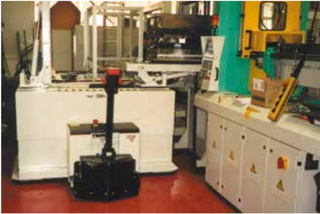
**Un chariot électrique special dédié au changement de moules de 1700 kg aussi utilisé comme unité d'inspection.**
