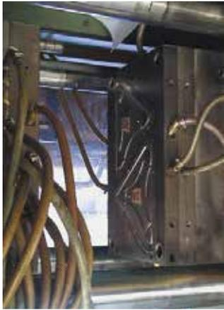
*Un exemple de la manière correcte de raccorder les différentes connexions de fluides sans le risque de fuites et de mauvaises connexions. En association avec un bon filtre à eau, ce dispositif réduira la quantité des rejets et améliorera la qualité de votre production.*
