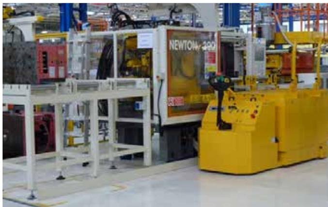
*Chariots de changement de moules 2 x 2 tonnes, à motorisation électrique et desservant plusieurs machines et unités de stockage.*
