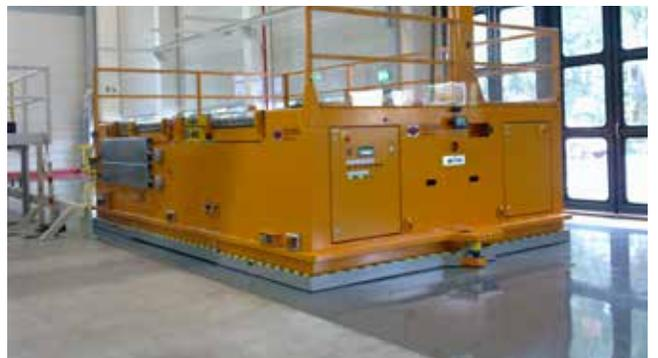
Les solutions de systèmes sur coussin d'air peuvent être très intéressantes pour les demandes de manutention de plus petits moules. Elles peuvent aussi être combinées avec un système à alimentation électrique pour des déplacements sur de plus longues distances. L'opérateur peut, soit marcher derrière ou même s'asseoir à bord du chariot. Contactez EAS pour des solutions tout à fait créatives à vos problèmes de manutention de moules.
