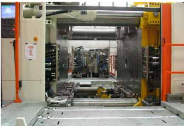
*De chaque coté de la machine, une table de changement de moules avec multi coupleurs pour le pré-chauffage et le refroidissement.*
