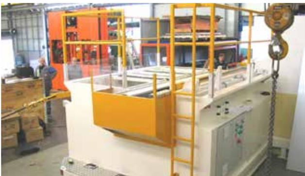
Comme l'espace était très limité autour et au-dessus des machines de ce fournisseur de l'industrie automobile, deux chariots à suspension sur coussin d'air pour des moules de respectivement 2 x 20 t et 2 x 15 t peuvent procéder au changement de moules en moins de 15 minutes. Le système de changement par va-et-vient peut effectuer les changements de moule des deux côtés du chariot, ce qui représente encore plus de flexibilité et de rapidité.
