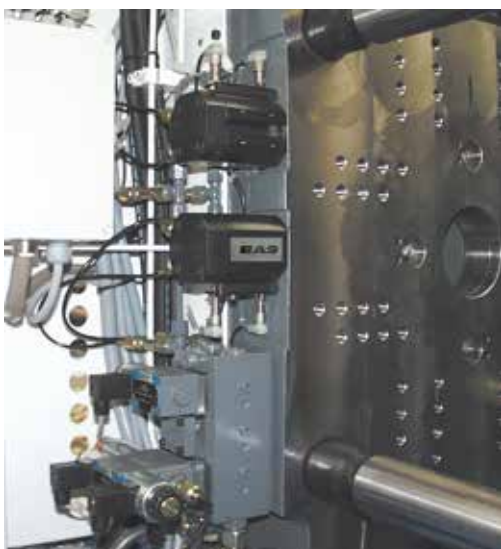
Hydraulisch integrierte Spannsysteme sind aus-gestattet mit 2 Näherungs-schalter zur Positionsüber- wachung
