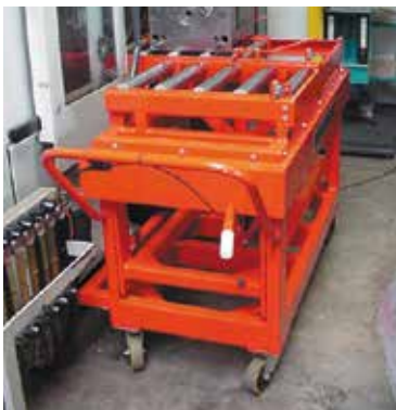
Die Werkzeuge werden von Hand geschoben und gezogen
