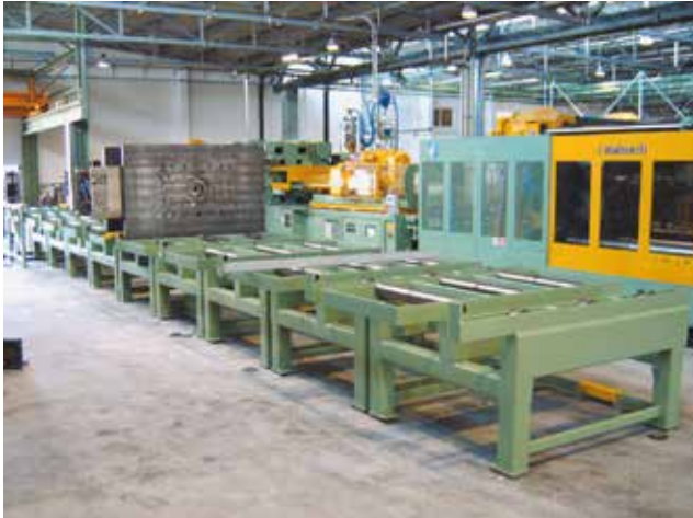
Werkzeuglager in Kombination mit einem schienengeführten Wechselwagen. Einer der Lagerplätze ist ausgestattet mit einer automatischen Multikupplung, um dort die Werkzeuge auf Fertigungstemperatur aufzuheizen.
