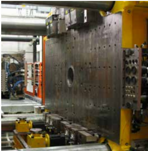
Horizontale Wechselvorrichtung mit einem 40 t Werkzeug von einem Werkzeugwechseltisch in eine 3200 t Maschine. Das System beinhaltet angetriebene Rollen, Zentrierzylinder, MOD 4010 Schnellspannzylinder und automatische Multikupplungen.
