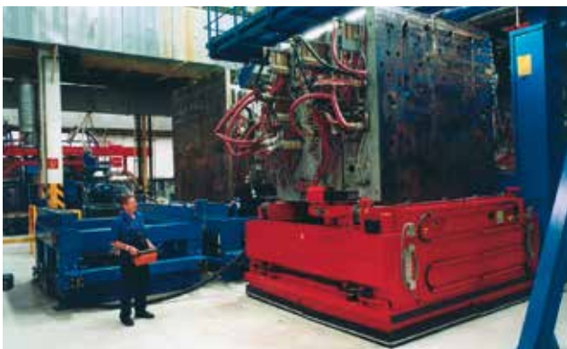
Für extrem schwere Werkzeuge wie bei diesem Containerhersteller installierte EAS dieses Luftkissensystem kombiniert mit Lagersystemen, einer 3400 t und einer 6000 t Spritzgießmaschine sowie einer EAS Inspektionsvorrichtung. Der Wagen kann Werkzeuge bis zu 150 t tragen und die Umrüstzeit beträgt weniger als 30 Minuten.
