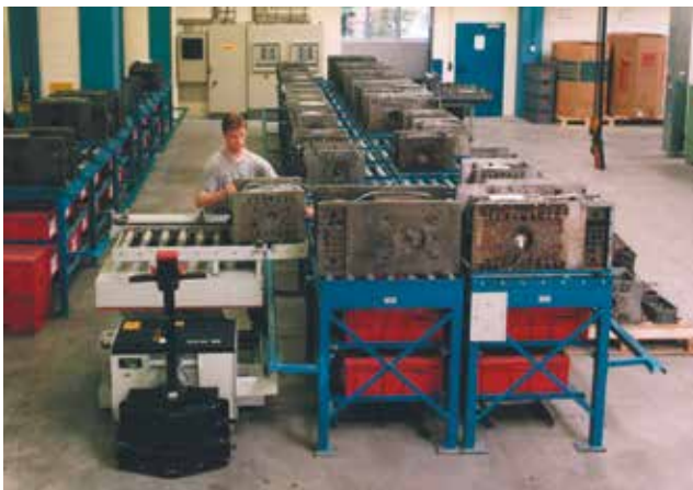
Dieses horizontale Werkzeuglagersystem wird beladen und entladen von einem elektrisch angetriebenen Werkzeugwechselwagen, mit dem die Werkzeuge entweder manuell oder automatisch ins Lager gebracht werden. Unterhalb der Lagerplätze ist Raum für werkzeugbezogene Einbauteile.
