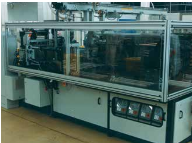
Eine 150 t Maschine mit einem '2-fach' Werkzeugwechseltisch, Vorheizung, Multikupplungen, hydraulischer Aufspannung und einer Auswerferkupplung. Die Temperiergeräte sind unter dem Tisch untergebracht und leicht zugänglich.
