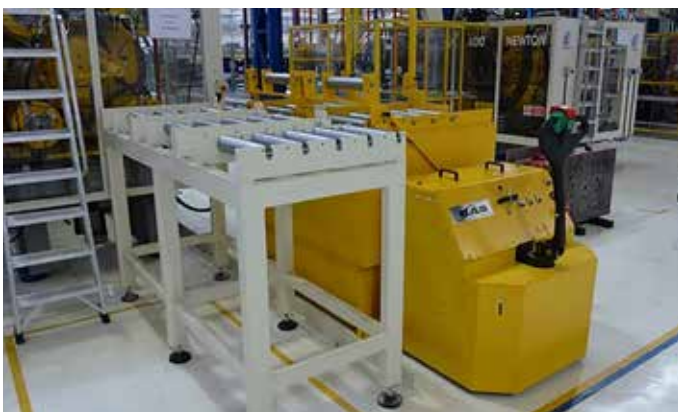
1 x 7 t Wechselwagen mit Höhenverstellung, zusätzlich Schub-Zugsystem mit Rollenbahn
