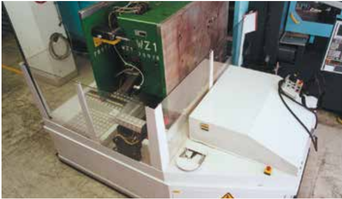
1 x 20 t mit kombiniertem elektrischen und Luftkissen-Antrieb für ein exaktes Positionieren vor der Maschine, Lagerplatz und Inspektionsvorrichtung.
