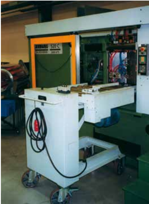
Unser manueller Werkzeugwechselwagen für ein Werkzeug von max. 800 kg
