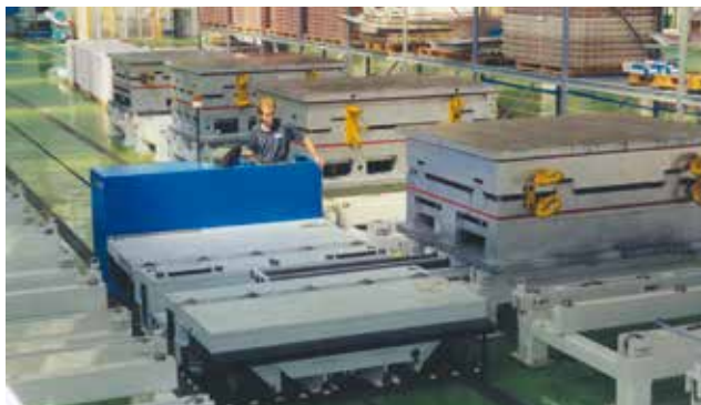
Dieser elektrisch verfahrbare Werkzeugwechselwagen für eine große Vertikalpresse kann die Werkzeuge weit ab der Presse zu einem speziellen Werkzeuglagerplatz bringen. Die Werkzeuge können nach beiden Seiten des Wechselwagens be- und entladen werden. Der Fahrer hat eine Kamera an der Stirnseite und einen Monitor am Bedienerstand. Somit ist er in der Lage exakt die Positionierung vorzunehmen. Das Wechseln der Werkzeuge und anschließende Lagern der 10 - 20 t schweren Werkzeuge erfolgt auf sehr einfache und schnelle Weise.
