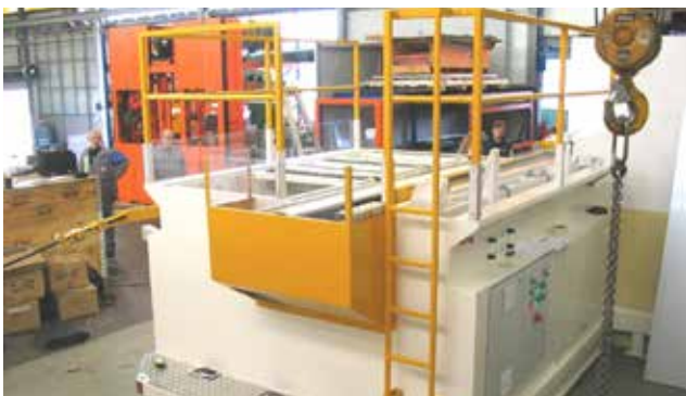
Der Raum um die Maschine sehr eingeschränkt für den Zulieferer für die Automotive Branche. Zwei Luftkissenwechselwagen für 1 x 20 t Werkzeuggewicht ermöglichen einen Wechsel in 15 Minuten.
