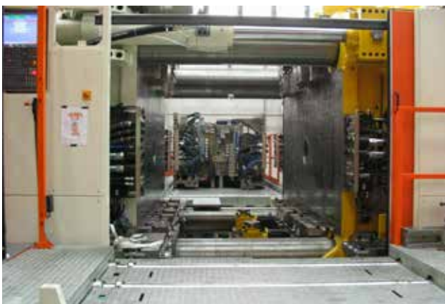
An beiden Seiten der Maschine ein Wechseltisch mit je einer automatischen Multikupplung für die Vorwärm- und Abkühlstation.
