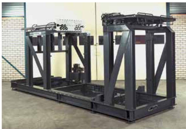
Diese separate Werkzeug-Vorheizstation wird für das Vortemperieren von Werkzeug von 20 bis 40 t außerhalb der Maschinen eingesetzt.
