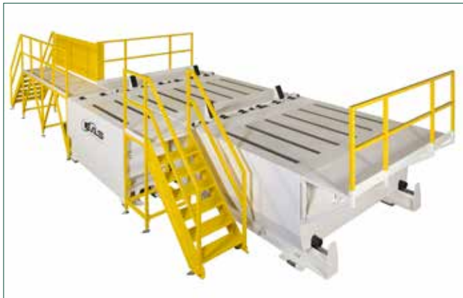
Werkzeugwechseltisch für 2 Werkzeuge mit max. 60 t Gewicht. Dieser Wechseltisch ist ausgestattet mit einer Vorwärmstation mit automatischen Multikupplungen
