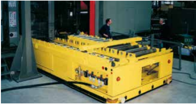
Ein 110 t Werkzeug wird von einem Transportsystem zur Spritzgießmaschine oder einer Inspektionsvorrichtung transportiert. Bei diesem Kunden, einem Hersteller von großen Plastikcontainern, stand für solch schwere Lasten kein Kran zur Verfügung; mit dieser Lösung kann er nun Werkzeuge innerhalb von 35 Minuten wechseln. Der Schub-Zug-Mechanismus ist eine einfache Spindelvorrückung, die die Werkzeuge in die große Tandemmaschine hineinschiebt oder aus dieser herauszieht.
