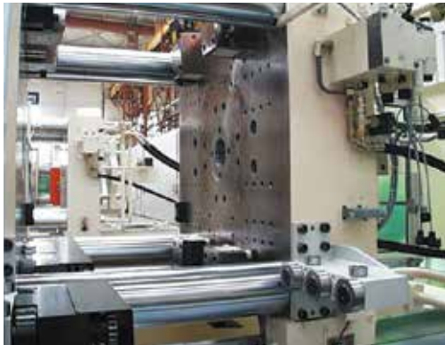
Angetriebene Rollensysteme an einer 500 t Maschine.
