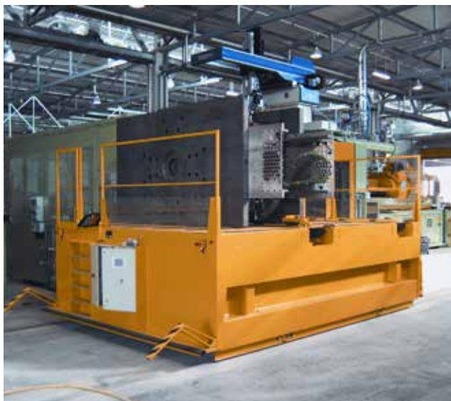
2 x 40 t Wagen zwischen 7 Maschinen
