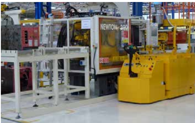
Elektrisch betriebener und frei verfahrbarer Wechselwagen für 2 x 2 t Werkzeuggewicht für den Einsatz an verschiedenen Maschinen und Lagerplätzen.
