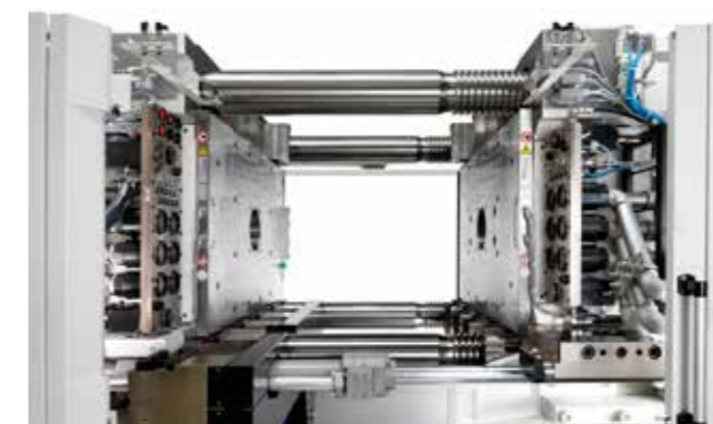
Pressmag LP sur une machine de 9000 kN (900 t)
