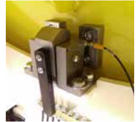
3 positions de verrouillage (0 ° -45 ° -90 °) avec surveillance
