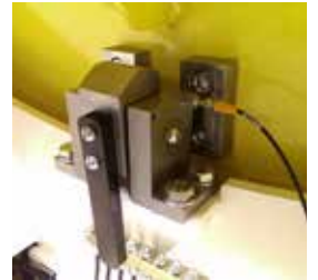
3 positions de verrouillage (0 ° -45 ° -90 °) avec surveillance
