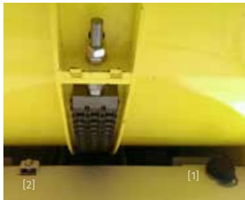
Topes finales con amortiguadores [1] e interruptor de proximidad [2]
