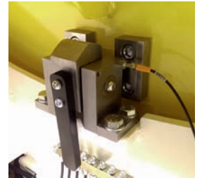
3 Verriegelungs- positionen mit Überwachung (0°-45°-90°)
