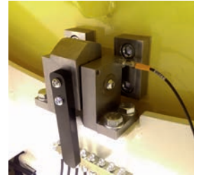
3 Verriegelungs- positionen mit Überwachung (0°-45°-90°)
