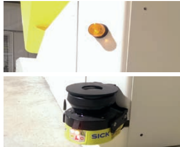
Laserscanner und flash lights - Warnlichter
