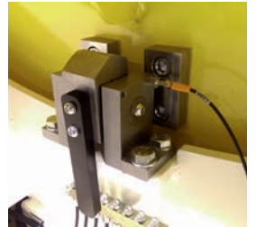
3 Verriegelungs- positionen mit Überwachung (0°-45°-90°)
