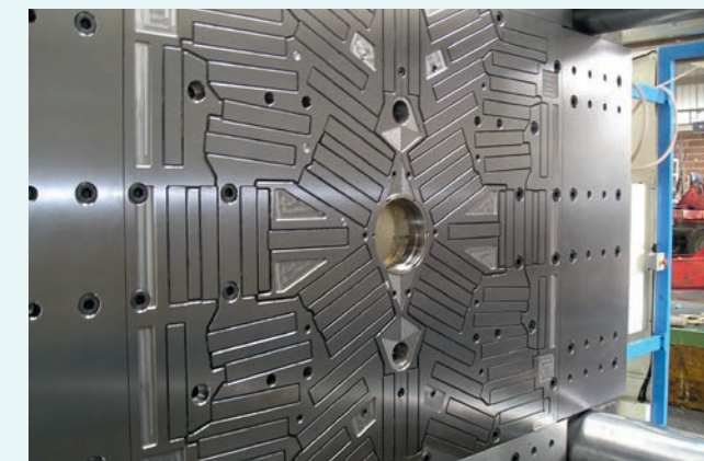
Pressmag HP sur une machine de 32000 kN (3200 t)
