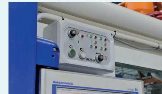
Unité de commande SCU
