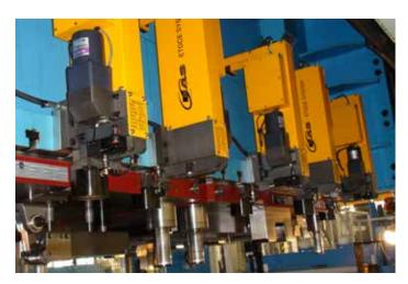
Verfahrbare Spannzylinder werden in der Regel auf großen Stanzpressen mit verschiedenen Werkzeuggrößen eingesetzt. Diese Systeme ermöglichen das automatische Spannen von großen Werkzeugen unterschiedlicher Größe, insbesondere auf dem Pressenoberteil.
