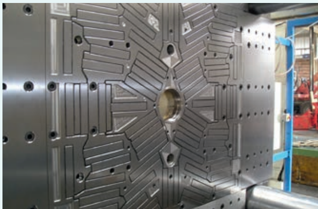
Pressmag HP auf einer 32000 kN Maschine
