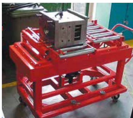
Il carro a doppia stazione permette di movimentare gli stampi in condizioni di sicurezza e semplicità.
