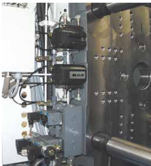
Sistema di bloccaggio oleodinamico integrato con posizione controllata da due sensori
