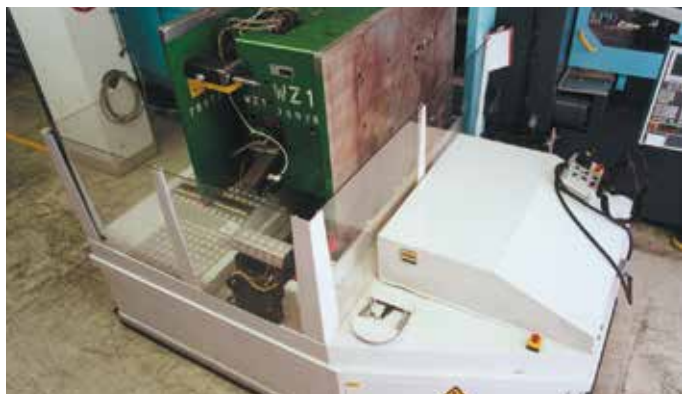
Carro (1 x 20 t) combinato a batteria / cuscini d'aria per un perfetto posizionamento di fronte alle macchine e alle unità di ispezione e di magazzino.
