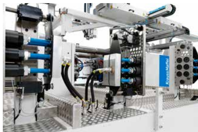
Tavola cambio stampi con stazioni di preriscaldamento integrate. Multiconessioni automatiche equipaggiate con connettori elettrici e innesti a perfetta tenuta
