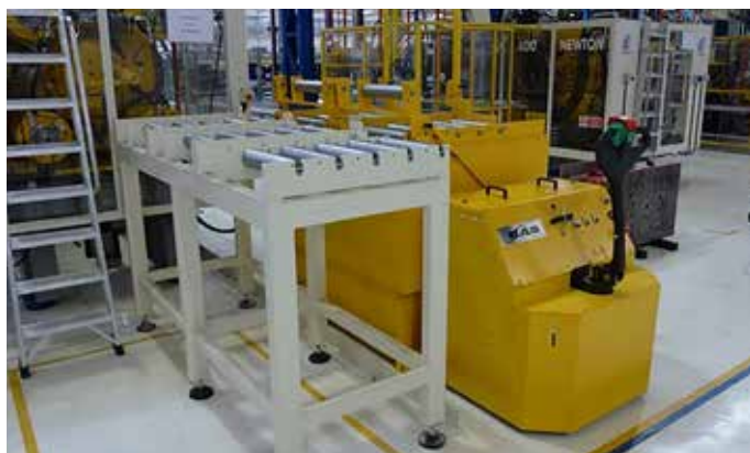
Carri di cambio stampi con regolazione in altezza, per 1 stampo di peso 7 ton, e sistema automatico di spinta e tiro su vie a rulli.
