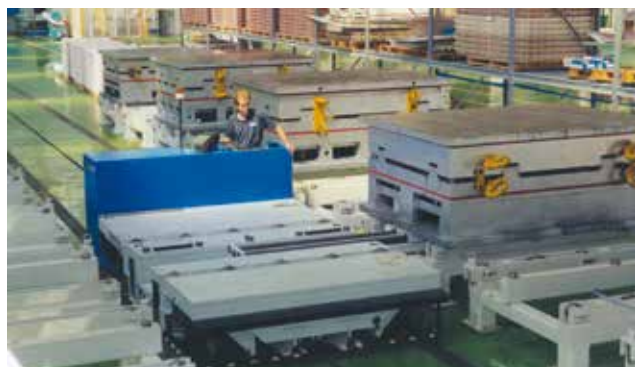
Il carro cambio stampo rappresentato nella foto opera su grandi presse verticali, può trasportare gli stampi lontano dalla pressa in una zona dedicata allo magazzino degli stampi. E' in grado di movimentare gli stampi sia verso il lato destro sia verso quello sinistro. Il conducente del carro dispone di una telecamera e di uno schermo, per facilitare l'esatto posizionamento del carro nelle zone operative. In questo modo il cambio e lo stoccaggio di stampi con peso compreso tra dieci e venti tonnellate è semplice, veloce e sicuro.
