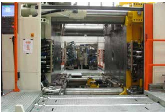
Entrambe le tavole di cambio stampi sono attrezzate con stazioni di pre-riscaldamento e raffreddamento stampi.
