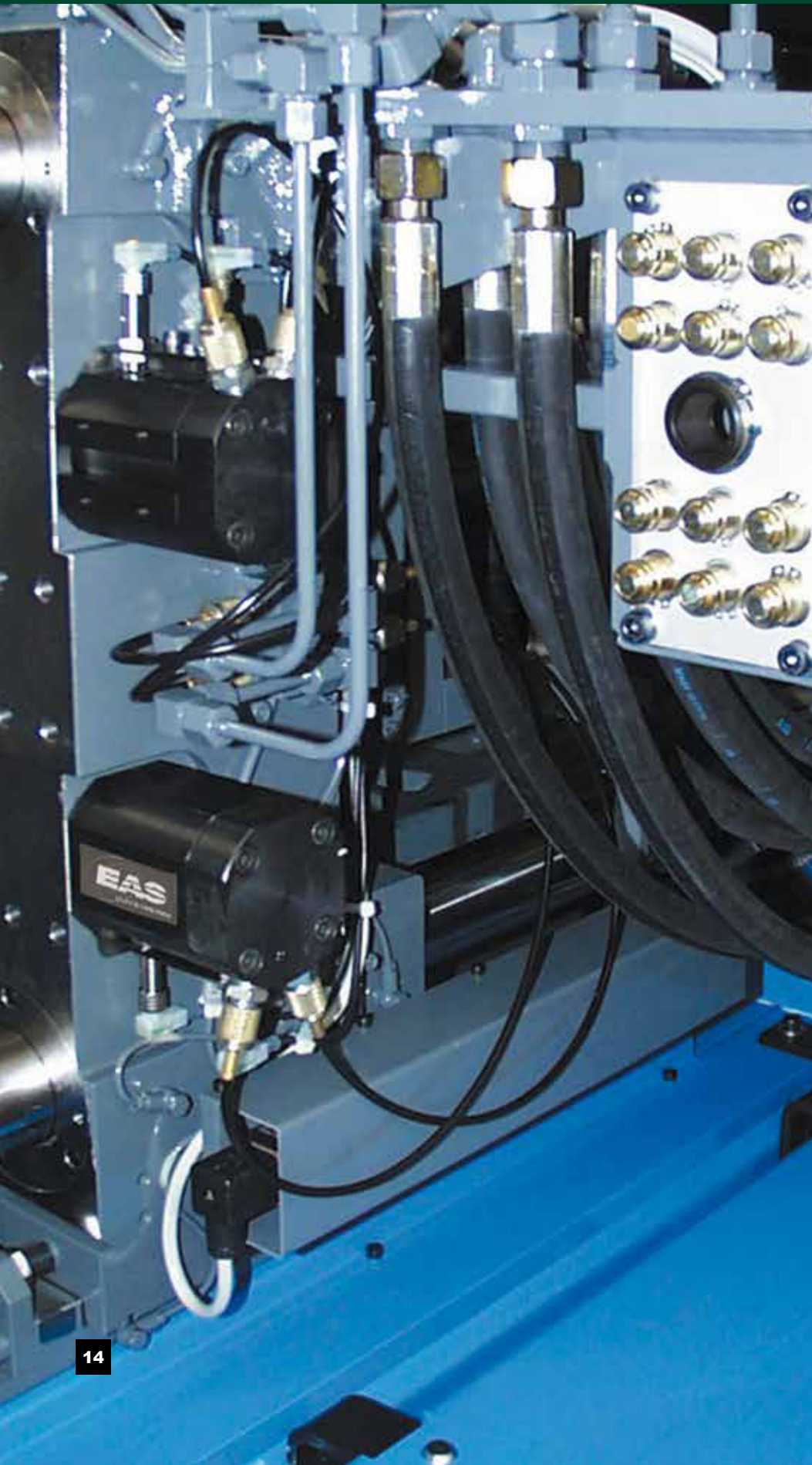
Caricamento orizzontale dello stampo con l'impiego di un sistema di bloccaggio integrato
