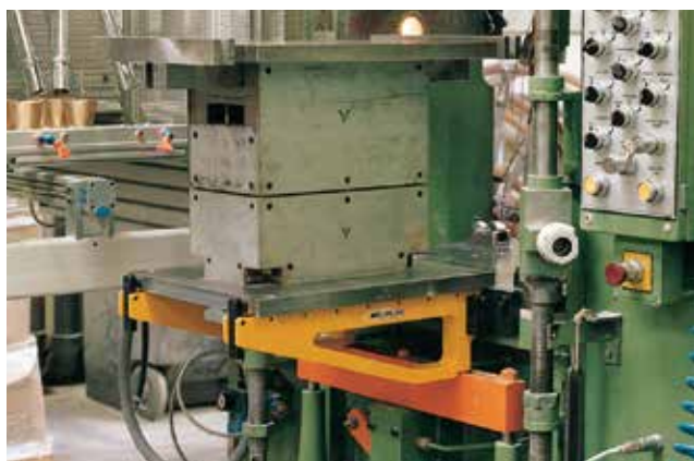
Bloccaggi stampo meccanici montati su una speciale piastra, in combinazione con le barre meccaniche di sollevamento stampi e le mensole a rulli. Il tutto attrezza questa pressa Duroplast. Una sola coppia di mensole viene utilizzata su più presse, grazie ai blocchetti ad aggancio montati su ciascuna pressa.
