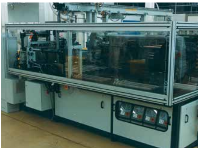
Una macchina da 150 t con tavola di cambio stampo a tre posizioni, sistema di preriscaldamento, multiconessioni, bloccaggio idraulico e un giunto per estrattore. Il sistema di preriscaldamento è collocato sotto la tavola ed è facilmente accessibile
