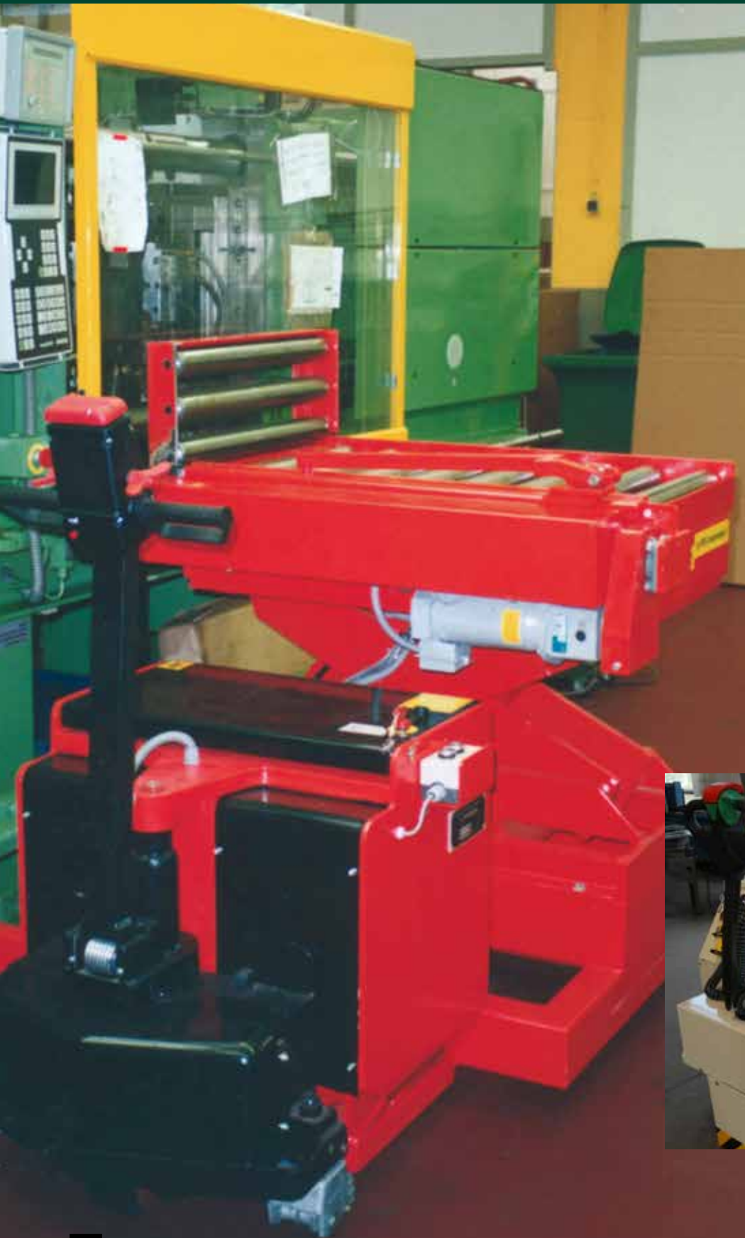
Carri di cambio stampi regolabili in altezza adatti per uno stampo di peso 4 ton
