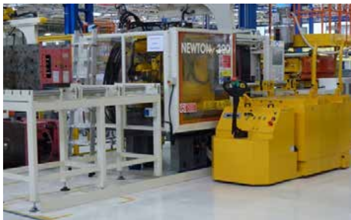
Carri di cambio stampi a trazione elettrica, per 2 stampi di peso 2 ton, adatti per servire più macchine e un magazzino stampi dedicato.
