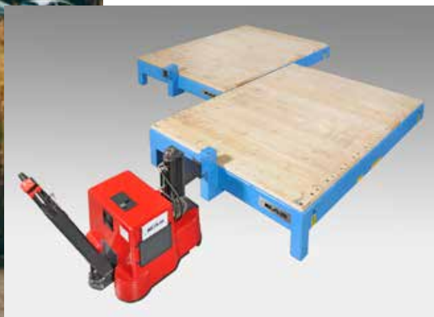
Tug unit per trasportare stampi di peso 20 ton.
