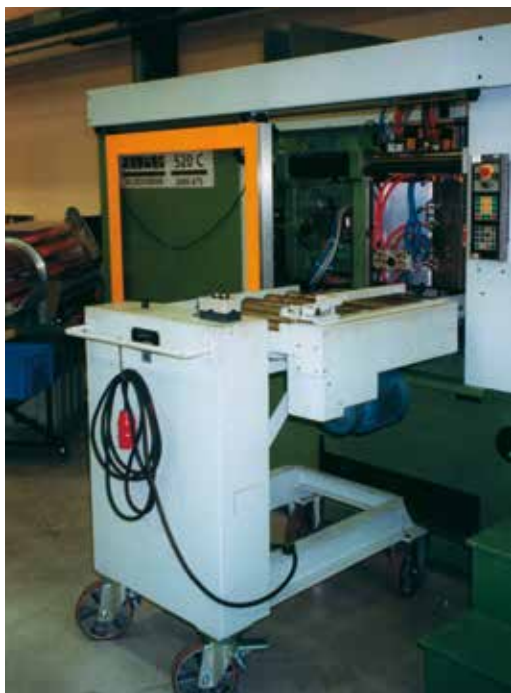
Il carro di cambio stampi per pesi fino a 800 kg.
