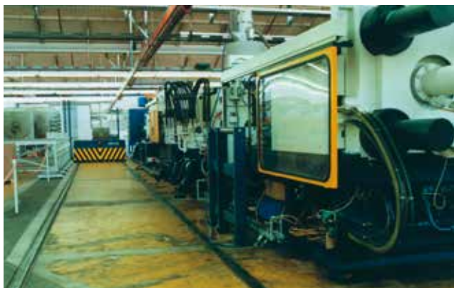
Carro 2x20 ton regolabile in altezza
