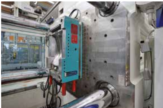
Pressmag SP su una pressa da 4000 kN (400 t)
