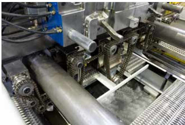
Parte interno macchina attrezzata con rulli motorizzati sul piano fisso.
