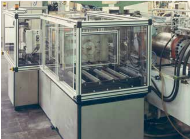
Un'unità produttiva completamente automatica con stazione di preriscaldamento funzionante con una macchina di stampaggio per iniezione da 250 t.
