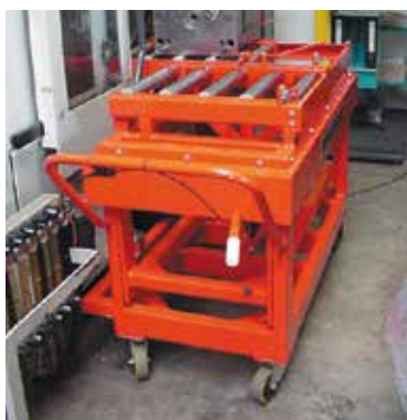
Il carro a doppia stazione permette di movimentare gli stampi in condizioni di sicurezza e semplicità.
