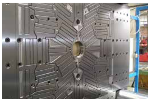
Pressmag HP su una pressa da 32000 kN (3200 t)
