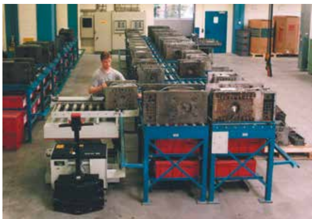
Nei sistemi di magazzino orizzontali gli stampi vengono caricati e scaricati mediante carri cambio stampi, manualmente o automaticamente. Possono essere a due livelli massimizzando lo spazio disponibile.
