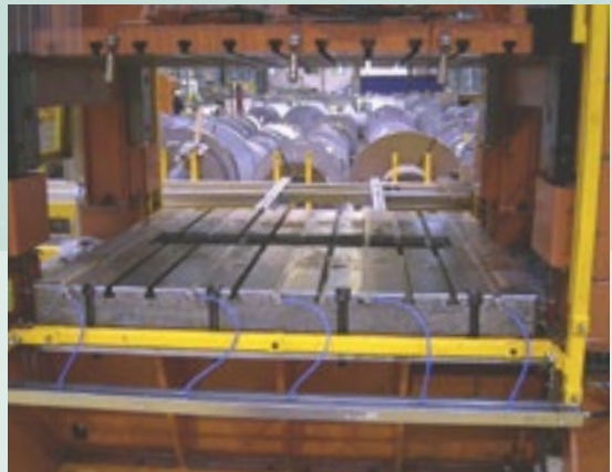
Règles à billes pneumatiques. Faciles à installer, faciles à enlever
