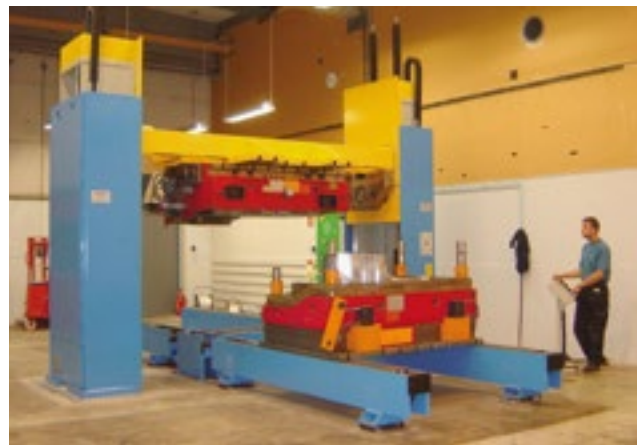
Un outil de 15 tonnes facilement séparé
