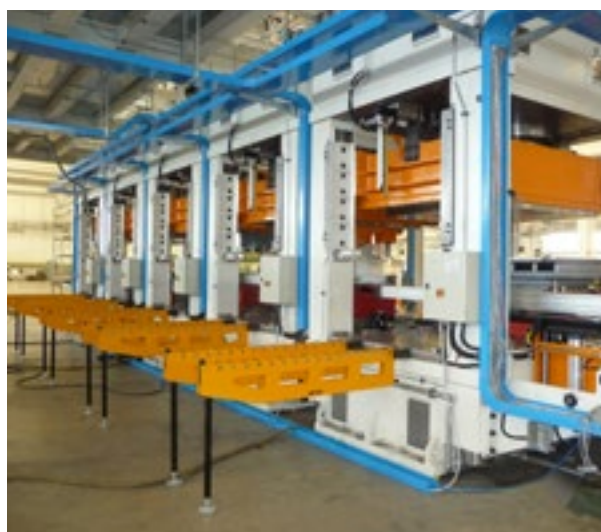
Groupe de presses équipés du système Pressmag SP100 ainsi que d'un guidage, de règles à billes pneumatiques et de consoles d'une seule source, EASchangesystems.
