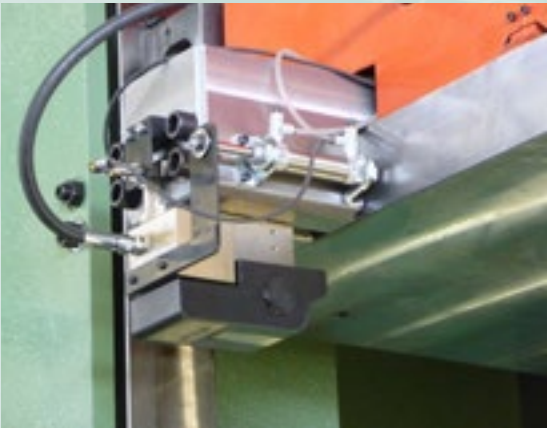
Vérin basculant à mouvement automatique par vérin pneumatique
