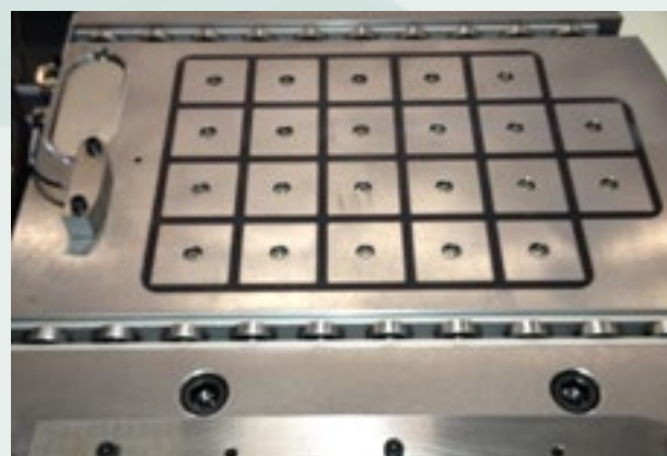
Plateau de presse avec butée à guidage latéral et règles à billes pneumatiques.
