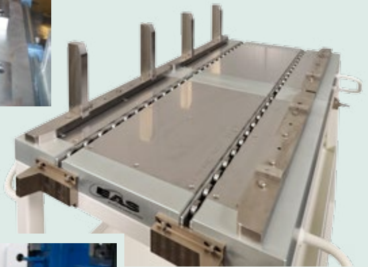
Chariot de changement d'outils équipé de règles à rouleaux pneumatiques et guidages latéraux.
