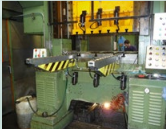
Grande presse avec brides MHC, règles à billes et consoles
