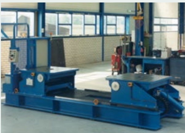
Une petite unité pour des poids jusqu'à 3 tonnes avec les deux plateaux tournant.
