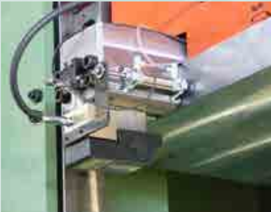
Kipphebelspanner mit automatisch verschiebbaren Pneumatikzylinder
