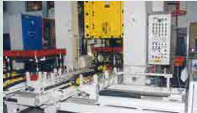
Beispiel einer vollautomatischen Formenwechselanlage mit einem schienengeführten Wechselwagen für 2 x 5 t Gewicht. In der Presse sind Hebeleisten und Schnellspannzylinder der Serie MOD montiert.
