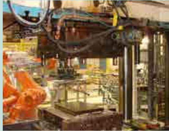
Hydraulische Spannvorrichtung mit Hebeleisten, Pumpe, Steuerung und Übernahmekonsolen
