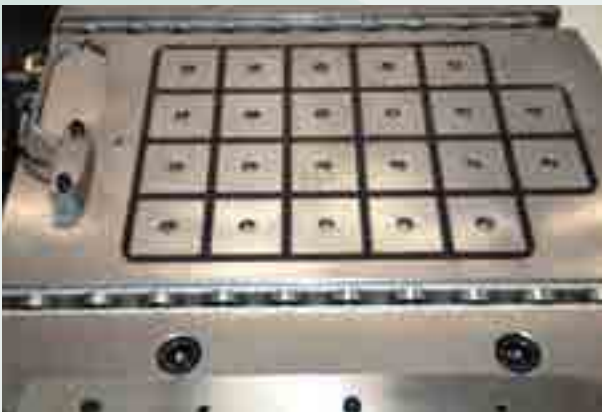
Tischplatte mit Seitenführung, Formenstopp und pneumatischen Hebeleisten.
