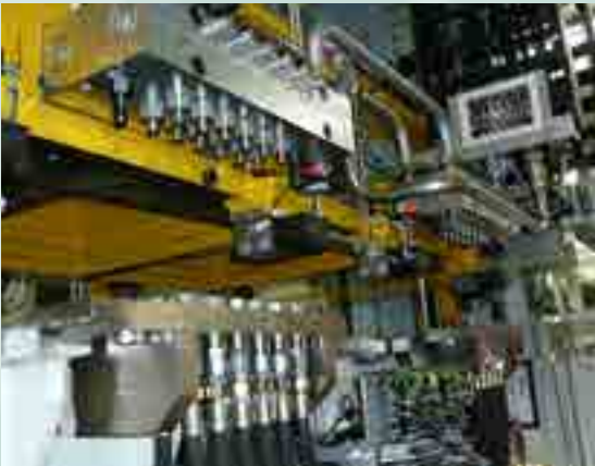
Hydraulische Spannvorrichtung mit Hebeleisten, Pumpe, Steuerung und automatische Multikupplungen
