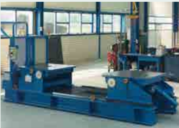
Kleine Vorrichtung für Formen bis 3 t Gewicht mit beidseitigen Aufspannplatten
