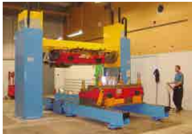
15 t Form kann leicht getrennt werden.
