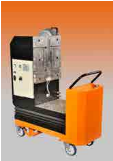
Formeninspektion und Transportstation für die Wartungsabteilung ausgestattet mit einem einfachen Magnetspannsystem um die Formen zu halten.
