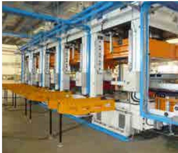
Gruppe von Pressen ausgerüstet mit Pressmag SP 100 mit Führungssystem, pneumatischen Hebeleisten und Übernahmekonsolen, alles aus einer Hand, EASchangesystems.
