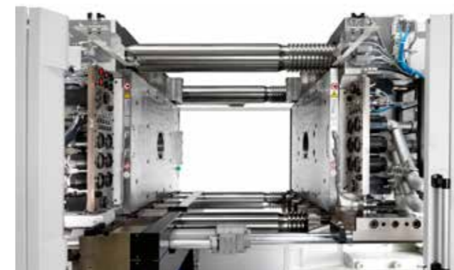
Pressmag LP en una máquina de 9000 kN (900 t)
