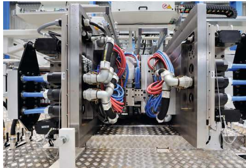
Bild 4. Heißkanalsystem und Werkzeugtemperierung werden für die anstehende Produktion in der Vorwärmstation auf Betriebstemperatur gebracht (Bilder: KraussMaffei/EAS)
