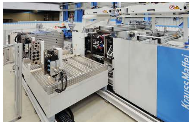
Bild 2. Der Werkzeug-Doppelwechseltisch steht in der Übergabeposition für einen automatischen Werkzeugausbau. In Vorwärmstation 2 wird das nächste Werkzeug bereits auf Betriebstemperatur gebracht
